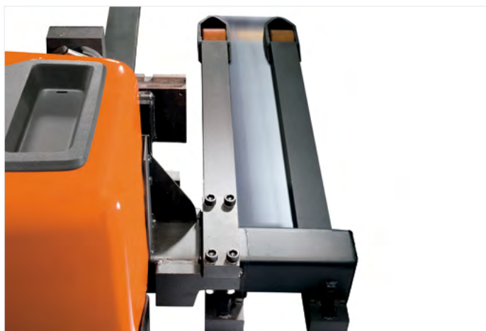
El modelo HWE100S se adapta a una gran variedad de tamaños de pallet gracias al ancho de horquilla ajustable.
