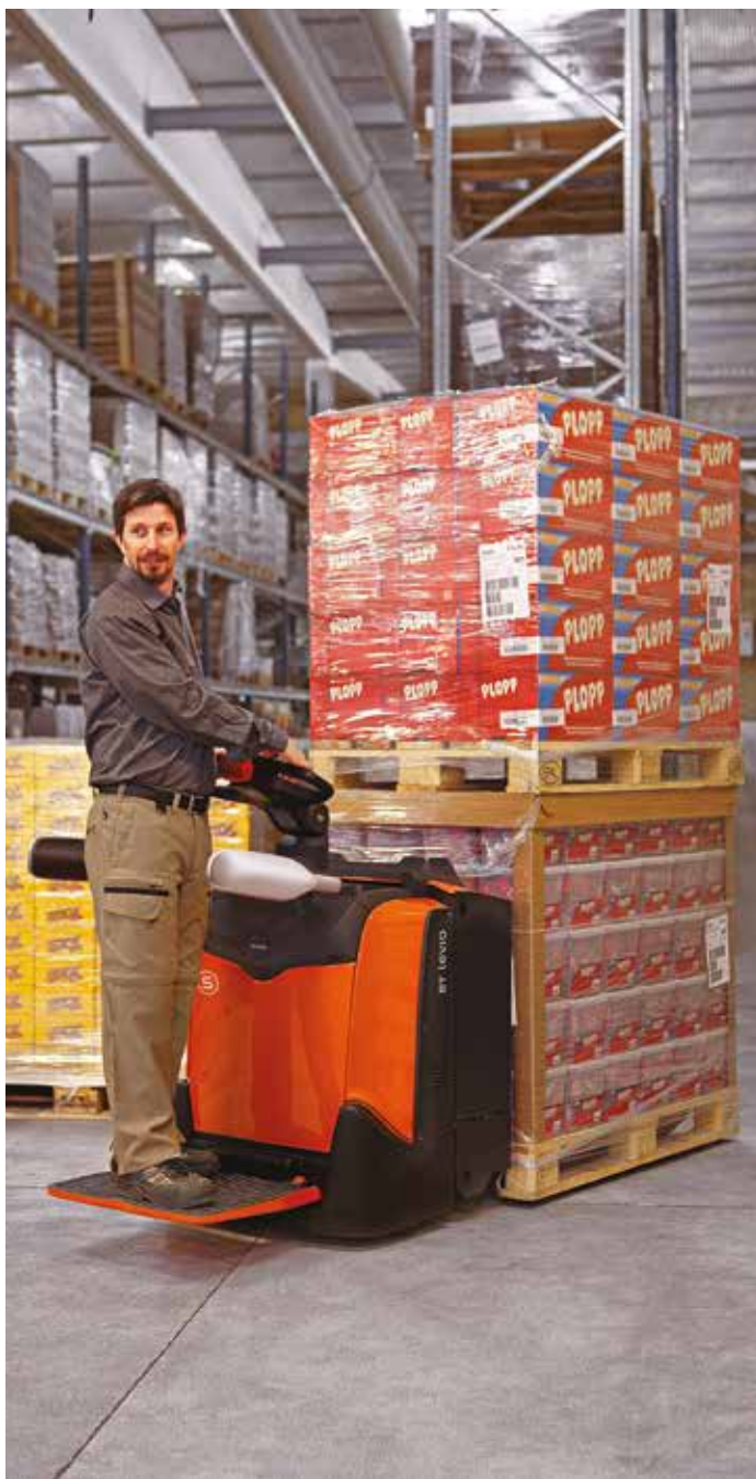
La altura del brazo timón se regula con solo tocar un botón.
