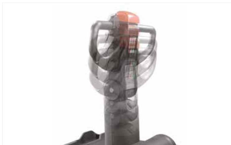
La altura del brazo timón se regula con solo tocar un botón.
